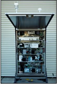
Remolque de Monitoreo de Aire: El sistema de remolque de monitoreo de aire funcionará como una plataforma semimóvil. Esta plataforma estará equipada con analizadores avanzados de monitoreo del aire con la capacidad de comunicar la calidad del aire a nivel comunitario en tiempo real.
