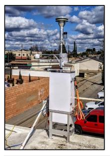
Sistema Compacto de Monitoreo de Aire de Múltiples Contaminantes: Estos sistemas compactos de control del aire funcionarán como plataformas semimóviles. Cada plataforma estará equipada con analizadores avanzados de monitoreo del aire que miden varios contaminantes, con la capacidad de comunicar la calidad del aire a nivel comunitario en tiempo real.
